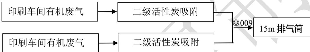
图 3-1 废气处理工艺流程图 (含监测点位)
